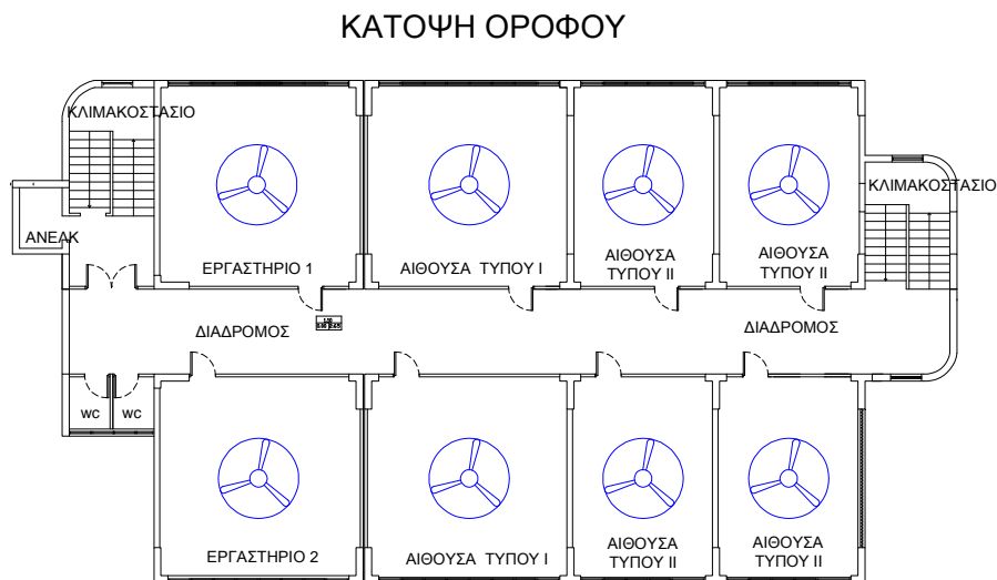
Σχήμα 13: Κάτοψη ορόφου σχολικού κτηρίου με χωροθέτηση των ανεμιστήρων οροφής.
